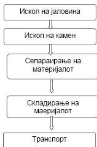
Слика 3. Дијаграм на технолошкиот процес на производство на сепариран материјал
